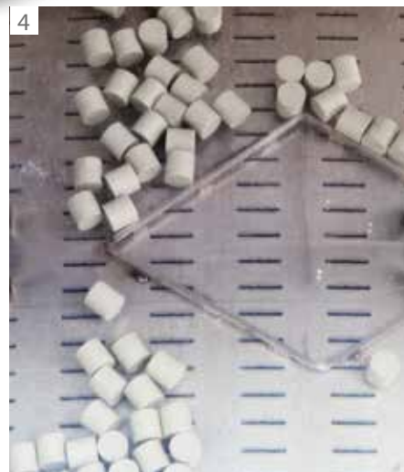
1 Pneumatische Pressanlage, Italien - 2 Einfüll-/Entleerungsöffnung bei der Version mit geschlossenem Tank - 3 Verdichter - 4 System mit Kugeln für die Innenreinigung der Saftkanäle
