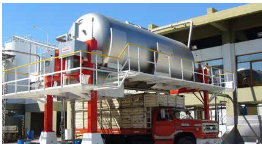
Impianto presse pneumatiche tank chiuso, Argentina Pneumatische Pressanlage in der Version mit geschlossenem Tank, Argentinien Пневматический пресс с закрытой емкостью, Аргентина
