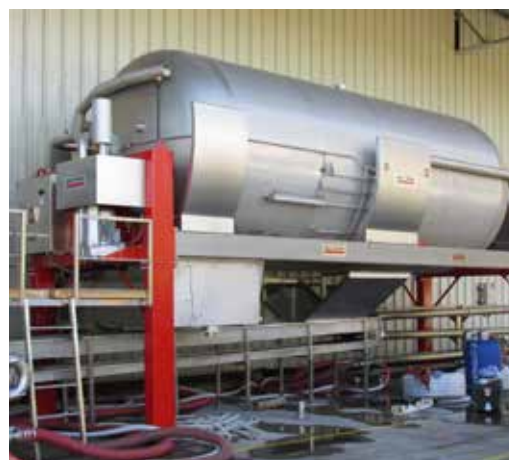
Impianto presse pneumatiche tank chiuso, Chile Pneumatische Pressanlage in der Version mit geschlossenem Tank, Chile Пневматический пресс с закрытой емкостью, Чили
