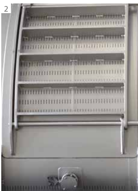
1,3 Impianto presse pneumatiche tank aperto, Chile - 2 Porta carico/scarico tank aperto
