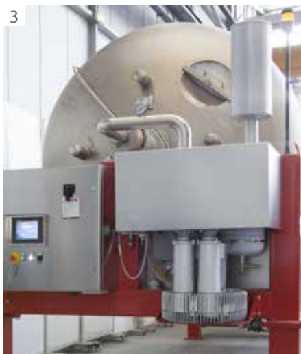
1 Impianto presse pneumatiche, USA - 2 Particolare sgrondo - 3 Particolare soffiante - 4 Pannello Touch-Screen - 5 Valvola ghioglitina 1 Pneumatische Pressanlage, USA - 2 Detail Saftablauf - 3 Detail Gebläse - 4 Touchscreen-Bedienpanel - 5 Flachschieber 1 Пневматический пресс, США - 2 Особая покатошь - 3 Особый обдув - 4 Сенсорный экран - 5 Гильотинный клапан
