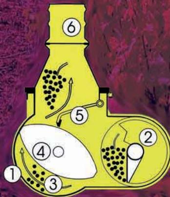
L'unità monoblocco (1) è costruita in acciaio inox AISI 304. Il prodotto viene convogliato da una coclea (2), fino all'interno della pompa (3), dove l'azione di un rotore ellittico in acciaio INOX (4), attraverso una valvola separatrice (5), lo spinge nella tubazione di uscita (6).
