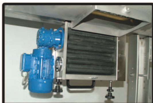
Gruppo pigiante "RF" Crushing group with rubber rollers Grupo moedor con rodillos de goma
